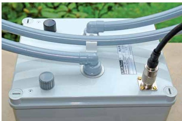
Bild 1: Schaltbox mit Bedienelementen und SO-259-Anschluss
