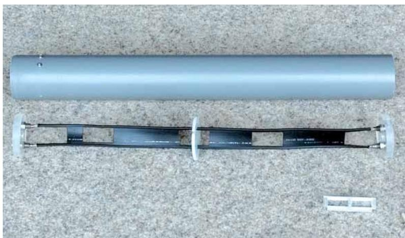
Die Mauerdurchführung umfasst als äußeren Träger ein PP-Abwasserrohr mit 50 mm Durchmesser und 1,8 mm Wandstärke, das in Baumärkten erhältlich ist.
