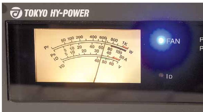
**Bild 7: Das geräteeigene Wattmeter stellt den Effektivwert der Leistung dar**
