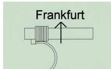
**Bild 6: So wird die Ferritantenne ausgerichtet**
