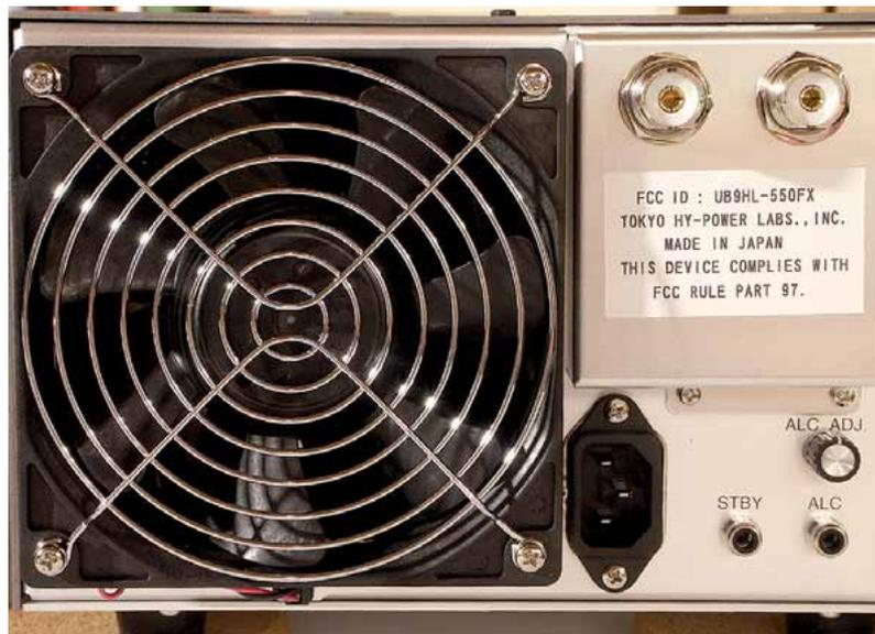
**Bild 5:** Auf der Rückwand sitzt der große Lüfter zur Kühlung des Schaltnetzteils und des HF-Verstärkers. Die beiden Koax-Buchsen für Input und Output sind von oben sichtbar beschriftet
