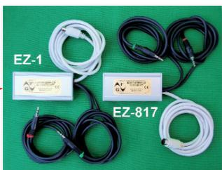
Das **EZ-1** und das **EZ-817** sind echte „Plug and Play“-Soundkarten-Interfaces. Sie brauchen kein Netzteil oder Batterie, sie belegen keinen USB- oder COM-Port, sie benötigen keine Spezialkabel oder komplizierte Jumper-Einstellungen.
