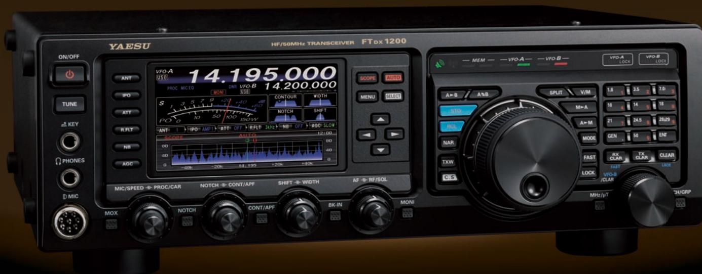
Ausgezeichneter Dreifachsuperhet-Empfänger, bei dem die Verstärkung optimal auf die einzelnen ZF-Stufen verteilt ist, sodass Signale außerhalb der Bänder den Empfang nicht beeinträchtigen.
