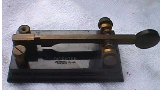
Abbildung H.2: “Double-Speed”-Taste; “Sideswiper”; dt. Seitentaste , patentiert 1888 von Jesse H. Bunnell. Der Tastenhebel bewegt sich horizontal zwischen den beiden Kontakten rechts im Bild hin- und her. Dadurch wird ein schnelleres Geben möglich, als mit einer “normalen” Handtaste. http://www.qsl.net/n6tt/pic/Bunnell_double_speedkey.jpg
